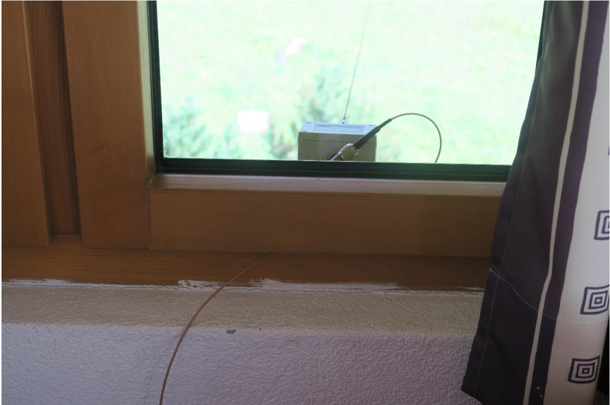
1:64 HF-Trafo auf der Fenster Aussenseite. Kabeldurchführung durch Entwässerungsschlitze mit RG-178 (Teflon). Auf der Innenseite im Dichtungsgummi eingeklemmt.
